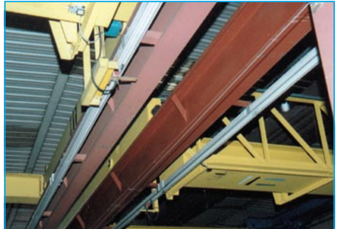
Fig. 2 - Principe d'entraînement et de raccordement électrique du chariot-collecteur sur pont roulant posé (voir fig. 4).
