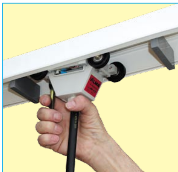
Fig. 1 - Extraction en cours de ligne du chariot-collecteur.
